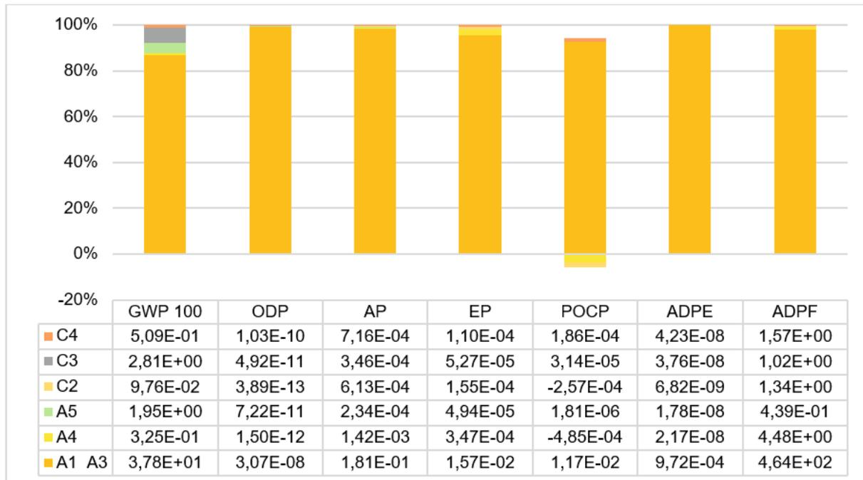
Das Ergebnis wird nahezu vollständig vom Produktionsstadium (Modul A1-A3) dominiert. Entsorgungs- und Transportmodule spielen fast keine Rolle.
