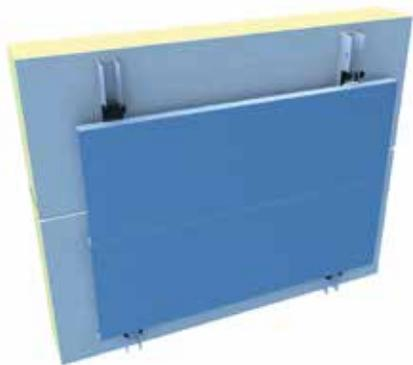
Hybrid FC Paneel auf Sandwichelement: vertikal, versetzt
